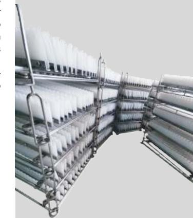
Nous concevons et fabriquons vos bouclards adaptés aux contraintes d'accrochage de vos pièces. Du montage facile de vos pièces, à la répartition idéale de la quantité de pièces, nos bouclards vous permettent d'optimiser le dépôt métallique, tout en apportant des solutions de préhension, du plus simple ressort à des systèmes plus complexes. Ses bouclards peuvent être revêtus de notre Rilsan, ou même au Plastisol
